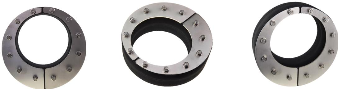
Dichteinsatz gegen drückendes oder nicht drückendes Wasser bestehend aus 1 x 30mm, 2 x 30 mm oder 3 x 30 mm starken Gummiplatten in EPDM 45 Shore, zwischen mind. 4 mm starken Edelstahl Druckplatten aus V2a mit Edelstahlschrauben ähnlich der DIN 603 mit M8 verschraubt und Sechskantmutter in V4a.
